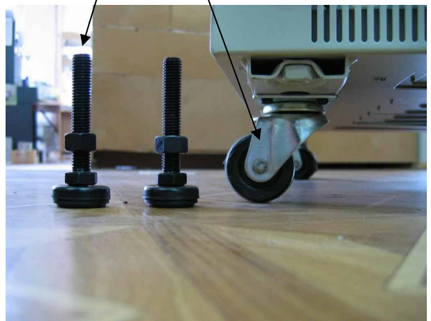
Колеса для переміщення (опціонально) та опорні ножки
